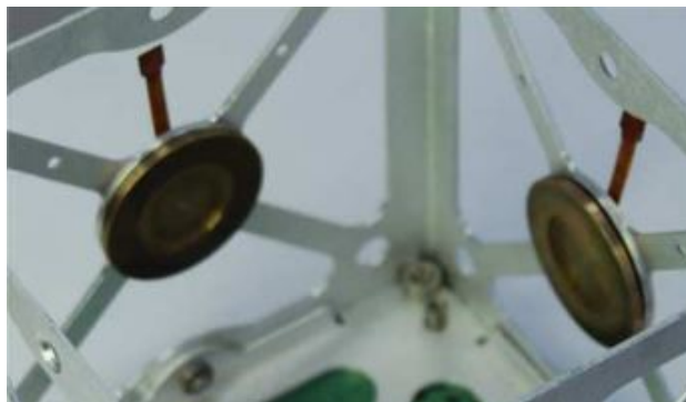
Figura 2.7: Dos Ruedas de Reacción del CubeSat Goliat.[3]
