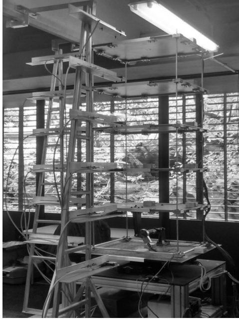
Figura 3.15: Prototipo a escala de un edificio de 5 pisos.
