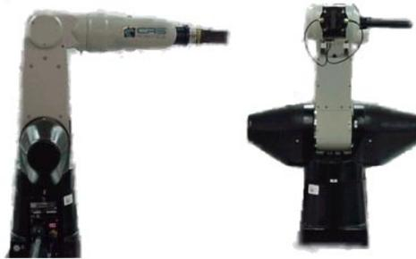
Figura 3.1: Robot CRS Robotics A465 con 6 grados de libertad.
