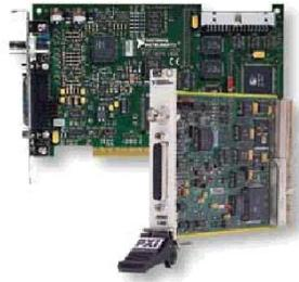
Figura 2.7: Tarjeta Digitalizadora PCI 1408.
