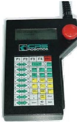
Figura 2.5: Control manual usado para manejar al robot A465.
