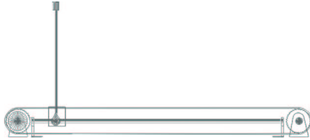
Figura 1.1: Esquema del péndulo invertido
