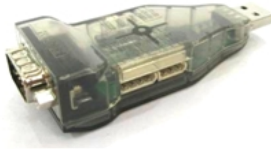
Figura 2.6: Adaptador USB2Dynamixel para comunicación con computadora
