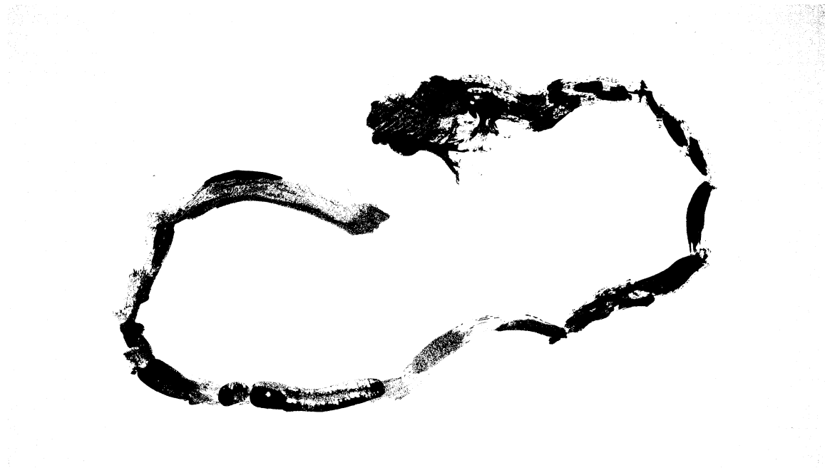
Figura 5.21: Movimiento circular capturado con navegación inercial propuesto
