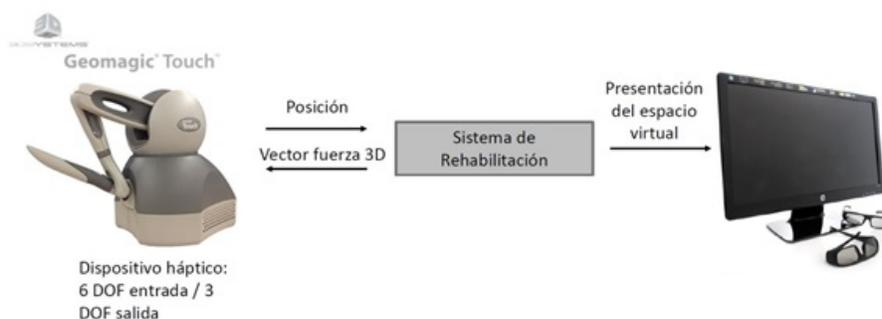
Figura 3.1: Elementos del sistema.
