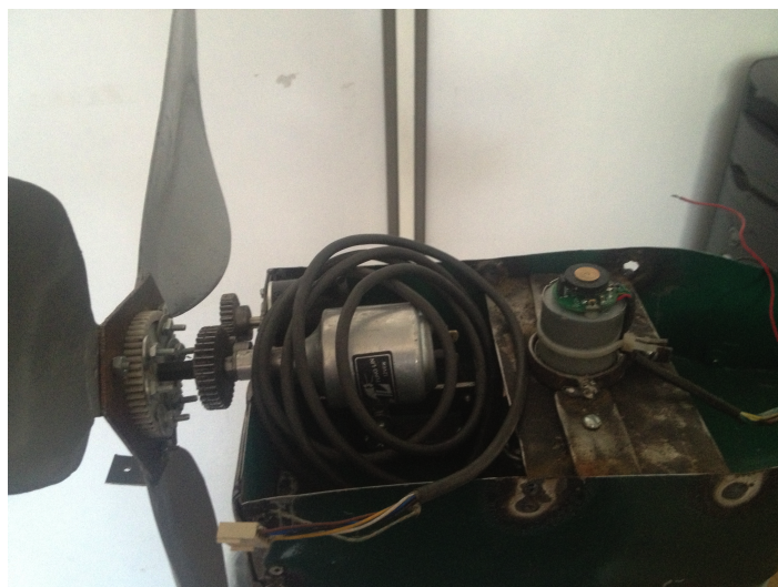
Figura 6.12: Montaje de Generador en Aerogenerador Propuesto
