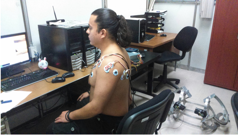
Figura 6.16: Colocación de electrodos para captura de señales EMG en el usuario.
