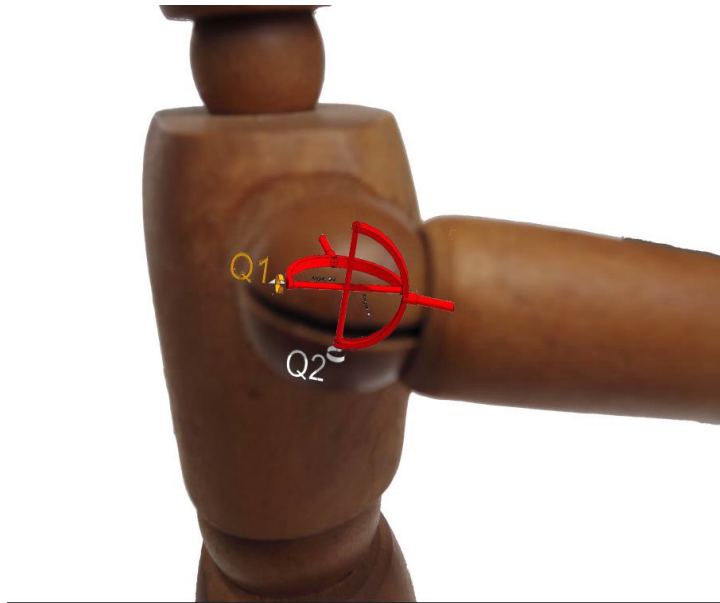
Figura 3.3: Hipotética superposición 2 de la junta universal con el hombro para mostrar los grados de libertad
